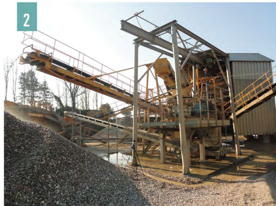
Installation de concassage, criblage et lavage
