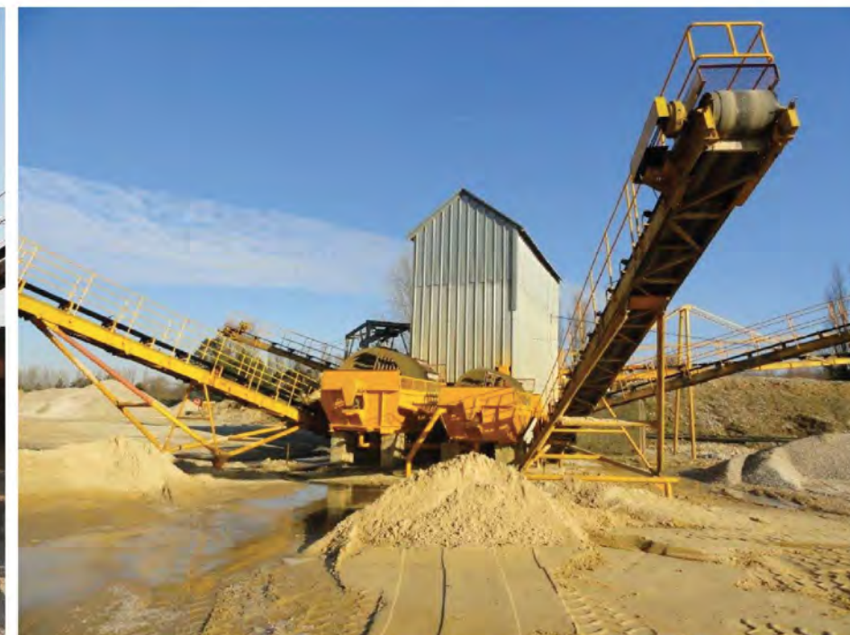
Installation de concassage, criblage et lavage
